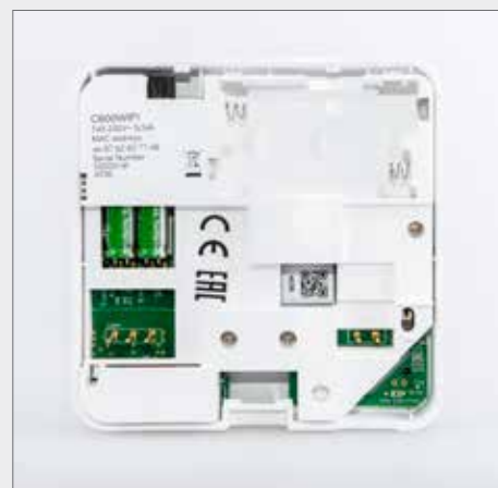
25. I codici identificativi e il QR code per la configurazione sono riportati sul retro dell'unità elettronica.
