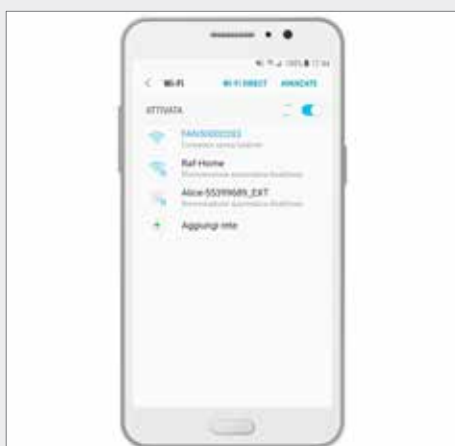
35. La rete da selezionare inizia per FAN, le cifre successive identificano il serial del cronotermostato.
