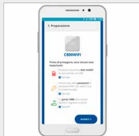
31. Disattiva la funzione dati mobili, annota la password di accesso al WIFI, apri la porta 1080 del router in ingresso e uscita.
