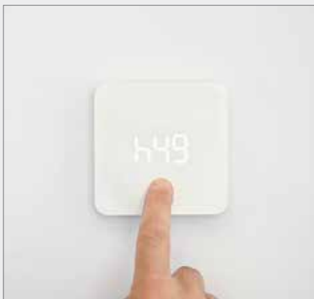
21. Premendo il tasto MODE per 2 secondi, puoi controllare il valore di umidità relativa rilevata in ambiente dal cronotermostato.
