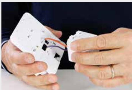
4. Per installare C800 WIFI in modalità doppia alimentazione, monta sulla base l'alimentatore a incasso C800 AL.
