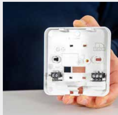
3. A sinistra ci sono i morsetti per il collegamento dell'alimentazione esterna, a destra quelli per il collegamento Relè (C-NA-NC).
