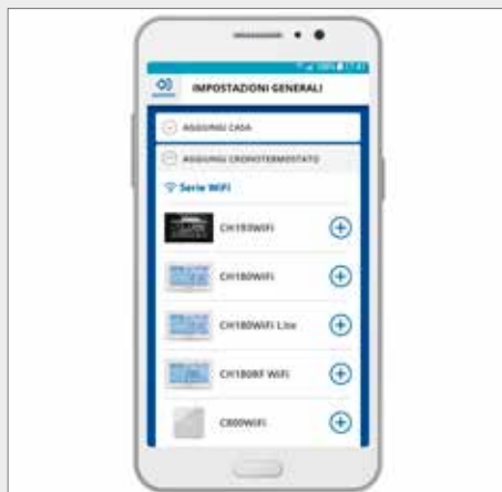
30. Seleziona C800 WIFI dall'elenco dei dispositivi configurabili con Intellimix+. Non mettere ora il cronotermostato in modalità AP.
