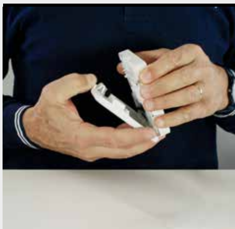
1. Separa l'unità elettronica di C800 WIFI dalla base (qui è stata usata quella quadrata).
