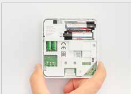
10. Inserisci 2 batterie AA nel vano dedicato per far funzionare il cronotermostato anche in caso di black-out.
