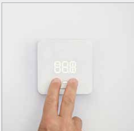
23. Premi insieme i tasti UP e DOWN per 3 secondi mentre tutti i segmenti/simboli compaiono sul visualizzatore.
