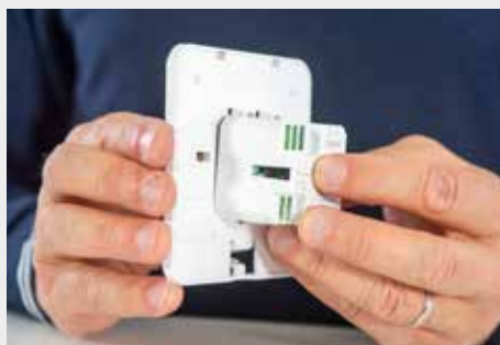
5. Aggancia l'alimentatore C800 AL agli appositi 4 dentelli posti sulla base di C800 WiFi.
