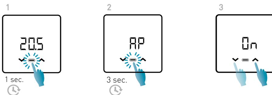
Appuyez sur MODE pour réactiver la commande à distance;
