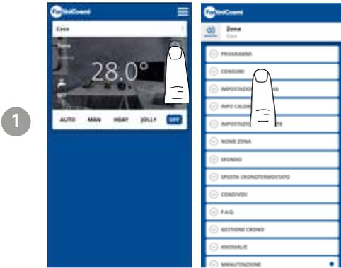
Depuis l'APP, il est possible de visualiser la consommation du SYSTÈME (heures de fonctionnement), de la commande à distance (charge de la BATTERIE) et les ÉCONOMIES D'ÉNERGIE réalisées grâce aux fonctions intelligentes du C800WIFIOTRQ.
