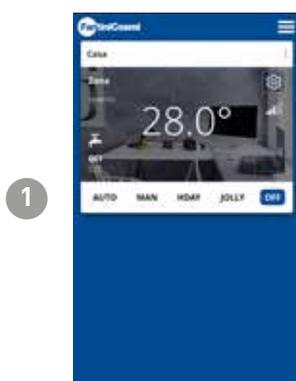
En mode OFF, la commande à distance est éteinte ou à la température de protection contre le gel si la fonction a été activée.
