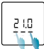
Bei eingeschaltetem Display können Sie durch Drücken der UP- oder Down-Taste den gewünschten Temperaturwert (Sollwert) ändern. Der Wert wird in Schritten von 0,1°C erhöht oder verringert.
