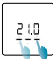
Когда дисплей включен, нажатием кнопок UP или DOWN можно изменить значение желаемой температуры (Set Point). Значение увеличивается или уменьшается с шагом 0,1°C.
