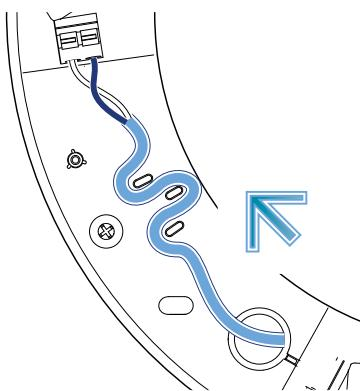
Legen Sie das Netzkabel wie abgebildet in den Zugentlastungskanal und schließen Sie die Stecker an die Schnellanschlussleiste an.
