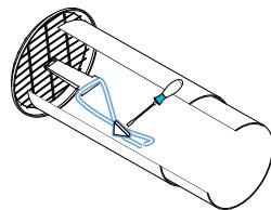
Befestigen Sie das Winkelstück am Rohr und verriegeln Sie die Sicherheitsschnur in den seitlichen Osen.
