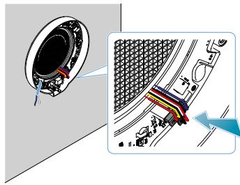
Setzen Sie die Dübel in die Befestigungslöcher und befestigen Sie das Gerät an der Wand, indem Sie das Stromkabel durch das vorgesehene Loch führen.
