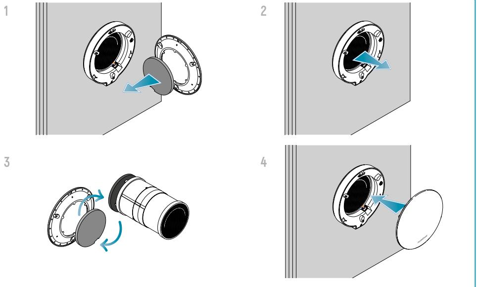
Denken Sie beim Wiedereinschalten des Geräts daran, den Filter und die Isolierplatte an der vorderen Abdeckung richtig zu positionieren, um den ordnungsgemäßen Betrieb des Systems zu gewährleisten.
