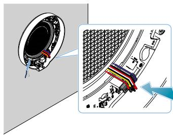
Préparer les chevilles au niveau des trous de fixation ; puis procéder à la fixation de l'unité au mur en faisant passer le câble d'alimentation dans le trou prévu à cet effet.
