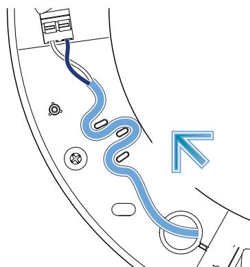
Placer le cordon d'alimentation dans le passage anti-traction comme indiqué sur la figure et connecter les connecteurs au bornier à raccordement rapide.
