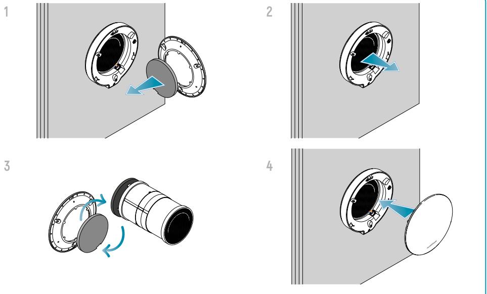
Lors du redémarrage de l'appareil, n'oubliez pas de repositionner correctement le filtre et le panneau isolant sur la coque avant pour assurer le bon fonctionnement du système.
