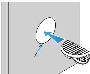
Stecken Sie das gebogene Gitter in das Teleskoprohr.
