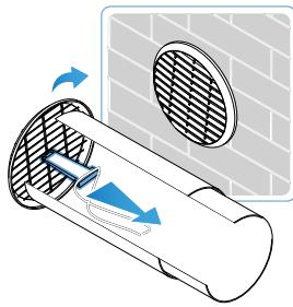
Bringen Sie das Gitter nach außen; drehen Sie dann das Gitter zum Öffnen und ziehen Sie es nach innen.
