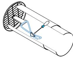
Befestigen Sie das Winkelstück am Rohr und verriegeln Sie die Sicherheitsschnur in den seitlichen Ösen.
