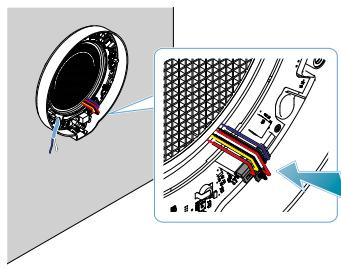
Preparar los tacos en correspondencia con los orificios de fijación; a continuación, proceder a la fijación de la unidad en la pared haciendo pasar el cable de alimentación por el orificio correspondiente.
