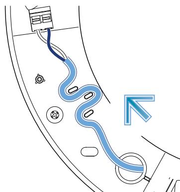
Coloque el cable de alimentación en el paso anti-tracción como se muestra en la figura y conecte los conectores al bloque de terminales de acoplamiento rápido.
