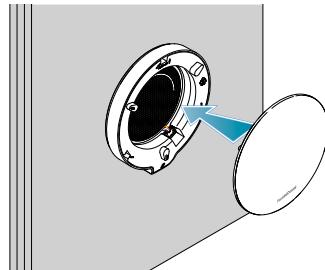
Al volver a encender el dispositivo, recuerde volver a colocar correctamente el filtro y el panel aislante en la cubierta frontal para garantizar el correcto funcionamiento del sistema.
